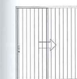
玄関アウトセット片引き戸(150頁平面図A部)立面図 縮尺1:100
