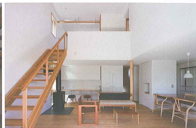
リビングを見返す。暖房は薪ストーブのほか、OMクワトロソーラーにより暖められた空気が床下へ送られ放熱する。
